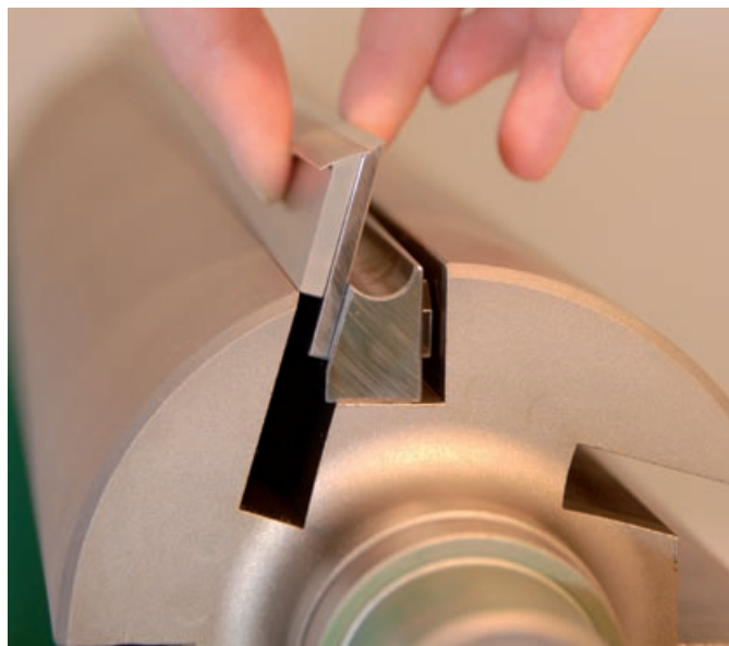
A gyalukés az adapterrel együtt kerül be a késnutba
