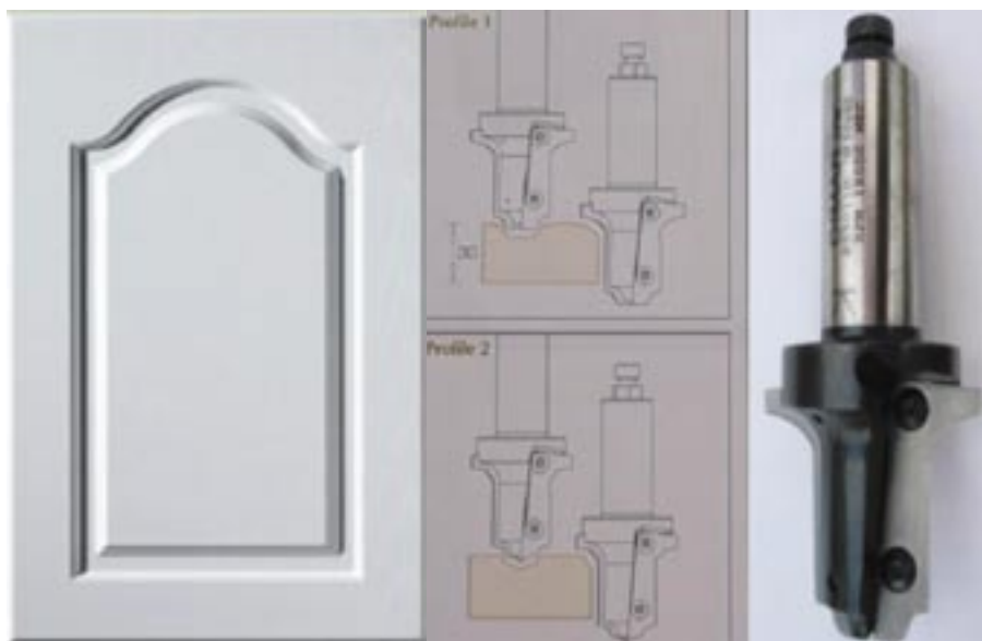
A multiszerszámmal mindkét marási művelet elvégezhető a munkadarabon
