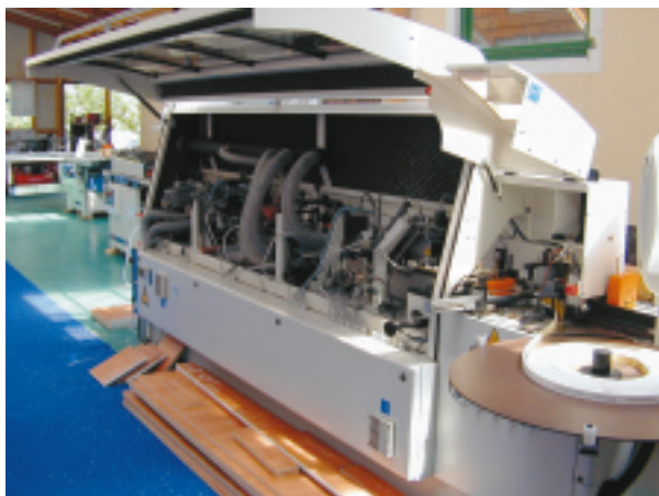
A NetLine-rendszerben az NC-vezérléssel ellátott éllezáró berendezés a vonalkód leolvasása után elindítja az éllezáró programot
